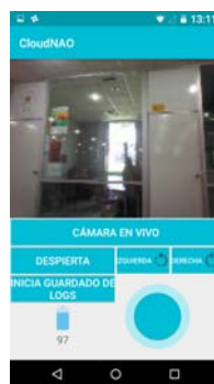
Figura 2.10: El control remoto muestra una imagen en vivo si se desea, el estado del batería y un joystick para mover al robot.
