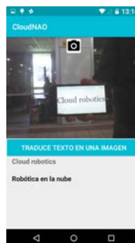
Figura 2.14: Al presionar el texto traducido el robot repite oralmente la cadena de caracteres.
