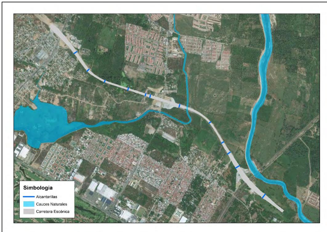
Ilustración 8-26 Ubicación de alcantarillas a través de la Escénica.
