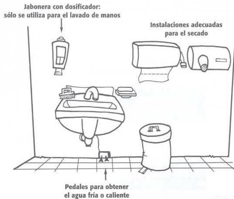
Figura 2. Componentes de la estación de lavado.
