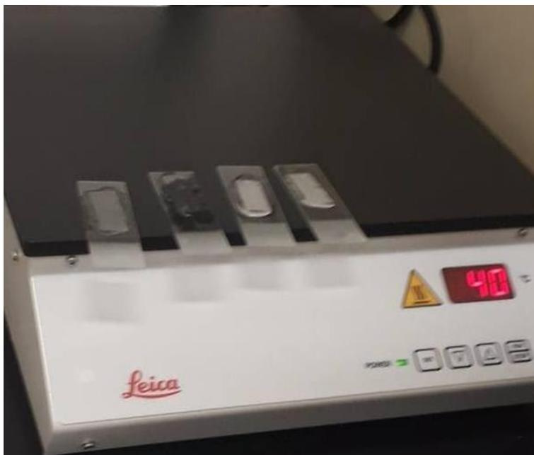
**Fig. 28.** Plancha de estiramiento.
