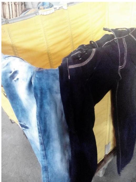
Figura 13. Pantalones de mezclilla en proceso de emulación de diseño. A la izquierda un pantalón con el acabado final, a la derecha un *jeans* con grapas, previo a ser lavado en cloro. Febrero 2016.
