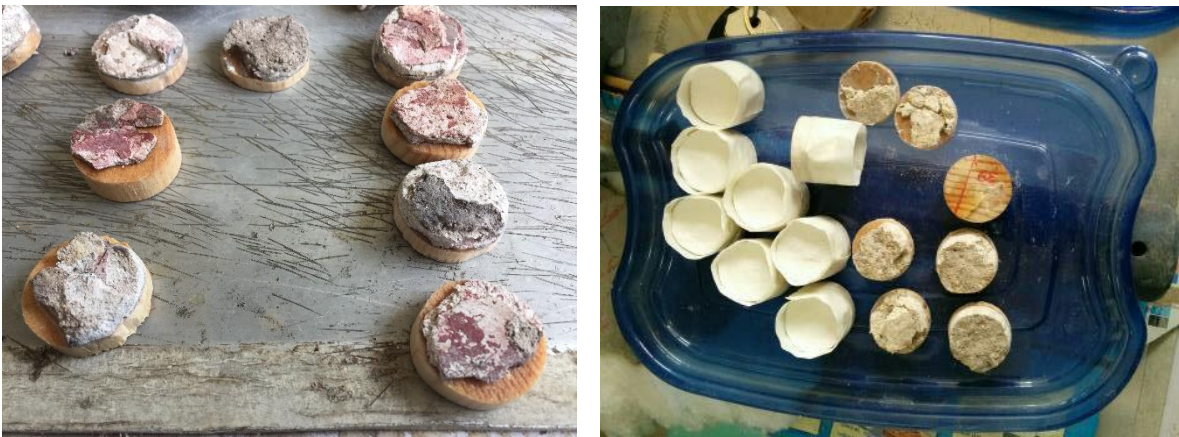
FOTOGRAFÍA 16 Izq. Ejemplares cortados del Piso Rojo. Dcha. Ejemplares pulidos y ejemplares con plastilina.
