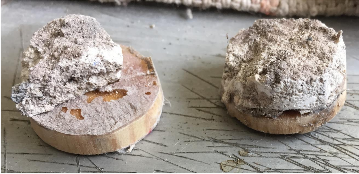
FOTOGRAFÍA 38 Especímenes de Piso blanco, muestra Piso 6, proceso de preparación de la muestra.
