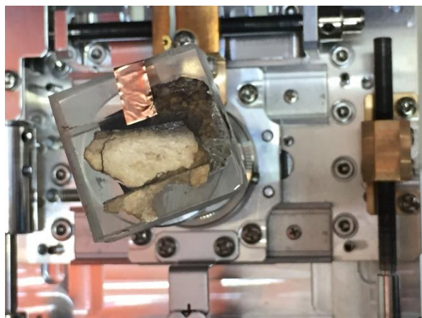
FOTOGRAFÍA 45 Izq. Bloque Piso Blanco montado en el porta objetos al interior de la cámara de vacío. Dcha. Muestra Piso Blanco, se aprecia la cara pulida con los dos fragmentos con corte transversal.
