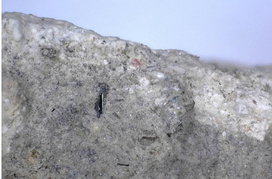
FOTOGRAFÍA 9 Muestra PN03. Detalle de la unión entre el firme y el enlucido. Se observa un posible fragmento de vidrio volcánico o cristal de hornblenda.
