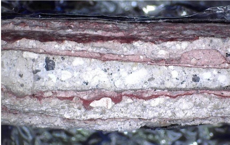
FOTOGRAFÍA 8 Muestra PR00, perfil estratigráfico. Se pueden observar diferencias entre los materiales de las capas.
