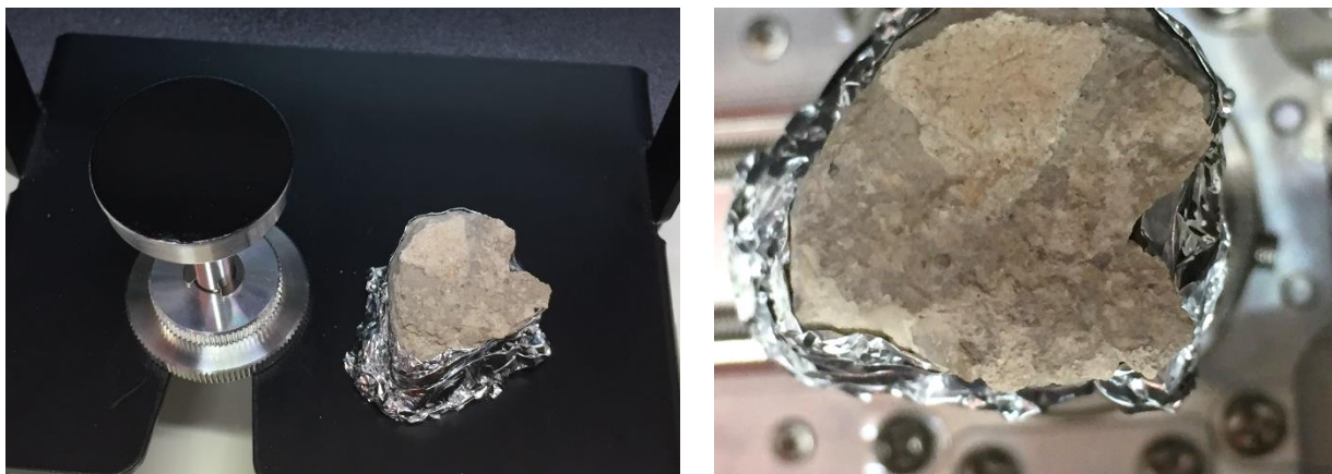
FOTOGRAFÍA 44 Izq. Fragmento del Piso blanco, comparándolo con el porta objetos del equipo de SEM- EDS.
