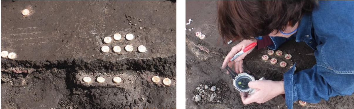
FOTOGRAFÍA 14 Izq. Colocación de soportes para la toma de muestras. Dcha. Lectura del azimut y la inclinación.
