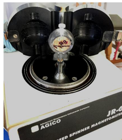
FOTOGRAFÍA 17 Izq. Equipo JR-6 (Magnetómetro), Laboratorio de Paleointensidades Magnéticas, I. Geofísica, UNAM. Dcha. Cabina donde se coloca el ejemplar.
