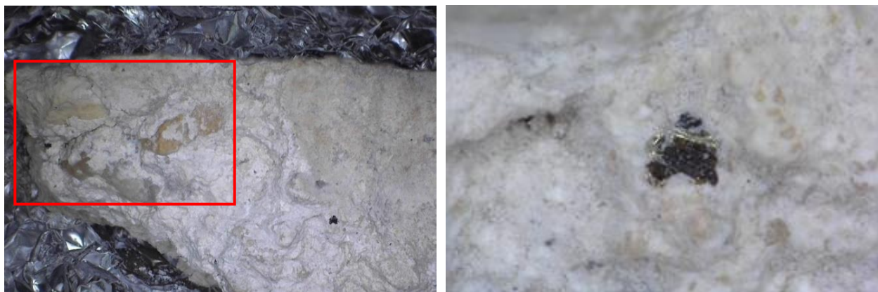
FOTOGRAFÍA 42 Izda. (PB01) Perfil del firme/20x/luz polarizada/ agregados geológicos de gran tamaño. Dcha. (PB01) Perfil del firme/200x/luz polarizada/posible fragmento de mica.
