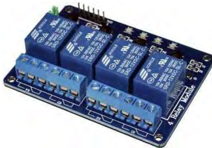
Figura 31. Módulo de cuatro relevadores. Al frente se observan las conexiones para el relevador (tres para cada uno) y al fondo a la izquierda se observan 6 pines, dos para la alimentación del módulo y cuatro para las señales digitales de activación o desactivación de cada relevador.
