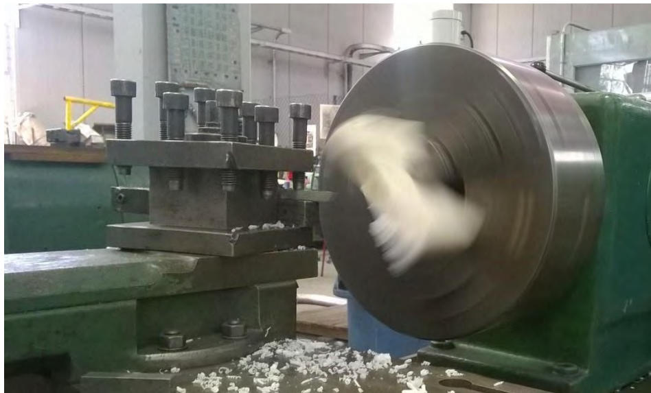
Figura 40. Maquinado en torno de las piezas de Nylamid para la base y el cople de M3.
