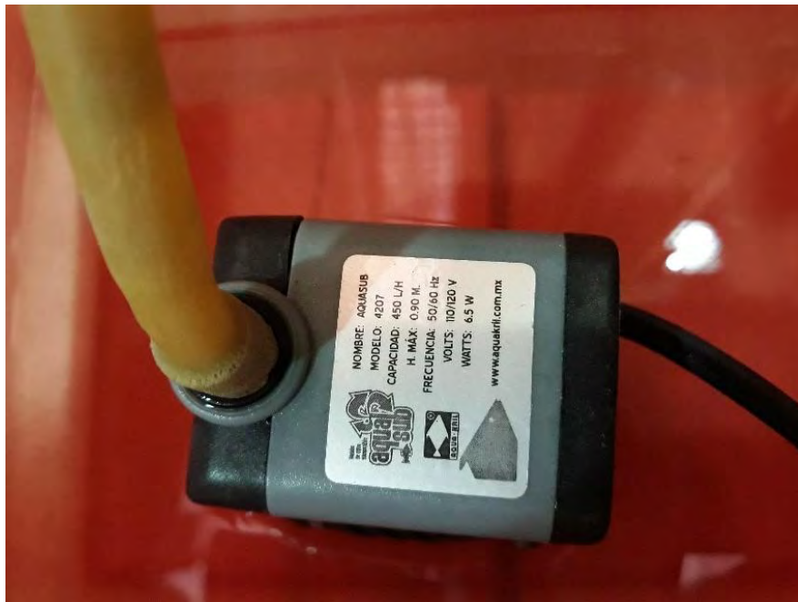
Figura 57. Bomba sumergible marca AQUA KRIL modelo 4207, utilizada como actuador para mantener el nivel de volumen de la celda de flotación (B3).
