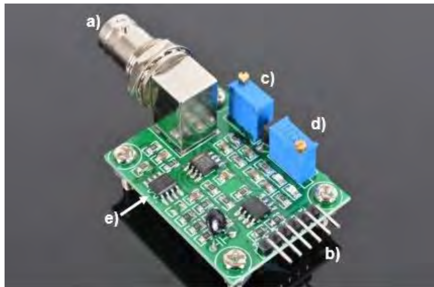
Figura 34. Sensor de pH y temperatura. Se observan 5 partes importantes. a) Conector BNC macho, b) pines para conexión de alimentación y señales de salida, c) potenciómetro para ajustar offset, d) potenciómetro para ajustar alarma de límite de pH y e) sensor de temperatura LM35.
