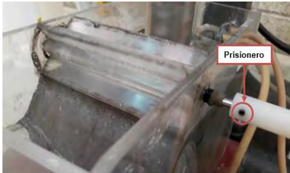
Figura 53. Detalle del mecanismo para extraer el concentrado de la celda de flotación. Se puede observar su flecha sujeta con el cople por medio de un prisionero.
