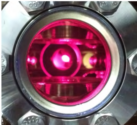
Figura 5.1: Fotografía de trampa magneto-óptica de {}^6\text{Li} .
