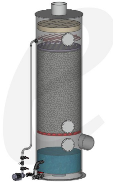
Figura 9. Lavador de gases. (ENQUIOL, s.f.)
