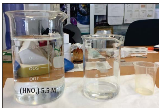
Figura 18. Vaso de precipitado con ácido ( \text{HNO}_3 ) 5.5 M y con una temperatura aproximada de 21^\circ\text{C} donde se sumergió la briqueta
