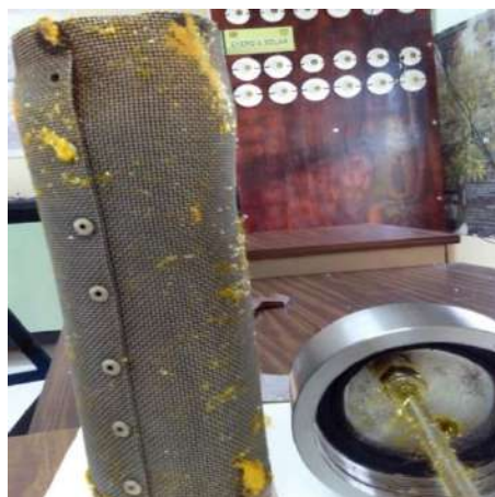
Figura 6. Extracto de perezona, a partir de A. platyphylla con CO 2 SC. Los cristales amarillos corresponden al producto aislado.
