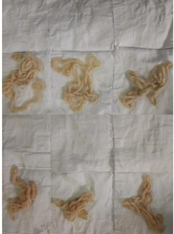
En cuanto a la prueba de frotado con los dos mordientes no se observó sangrado o restos de pigmento en las telas después de frotar por 10 minutos (Fig. 39).
