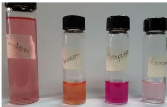
Fig 14. Extractos de los pigmentos diluidos con metanol para realizar las lecturas en el espectrofotómetro.
