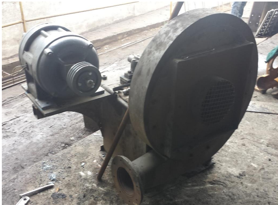
Figura 15. Motor e impulsor utilizados para insuflar aire en las toberas.
