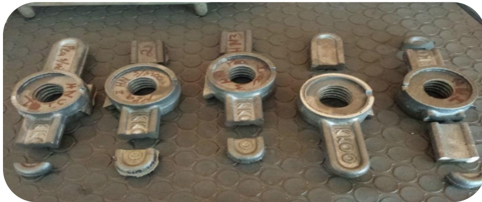
Figura 11. Pieza empleada en la prueba 3 para la caracterización microestructural y en la prueba de dureza Brinell.
