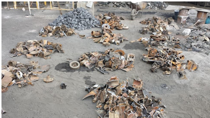
Figura 17. Selección de las chatarras para el horno de cubilote.
