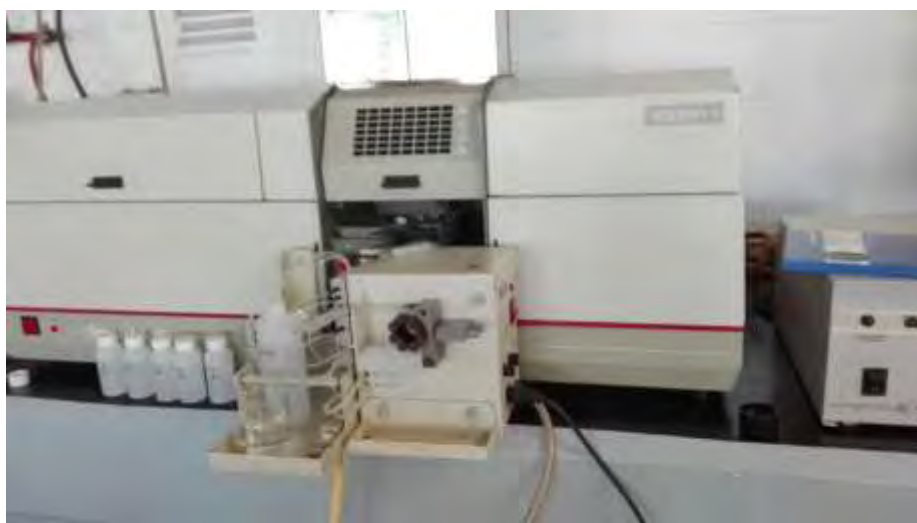
Figura 2.1. Fotografía del Espectrofotómetro de absorción atómica (SpectraAA800), con generador de hidruros (VGA77), que se usó (L-112, FESC, UNAM).
