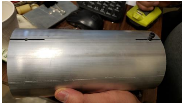
Fig. 13 Marcado de los barrenos
