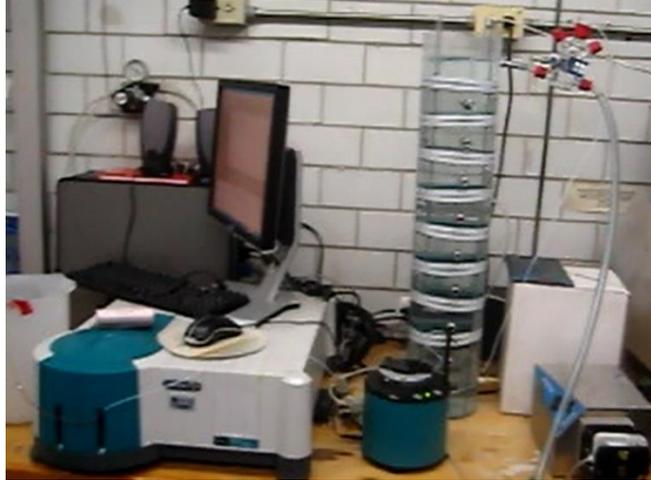
Figura 4.10. Sistema para determinar el régimen de flujo en el reactor
