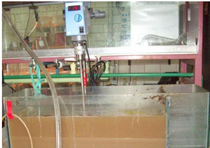
Figura 4.1. Recipiente de 20 L agitado para la aclimatación de los microorganismos
