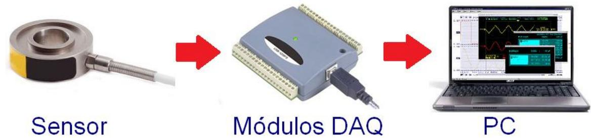
**Figura 3.3.** Esquema básico de la adquisición de datos.
