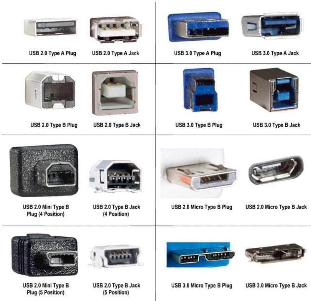
**Figura 3.8.** Puertos y conectores USB [15].
