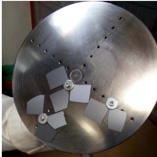
Figura 22. Muestras en el portasustratos para su aluminizado
