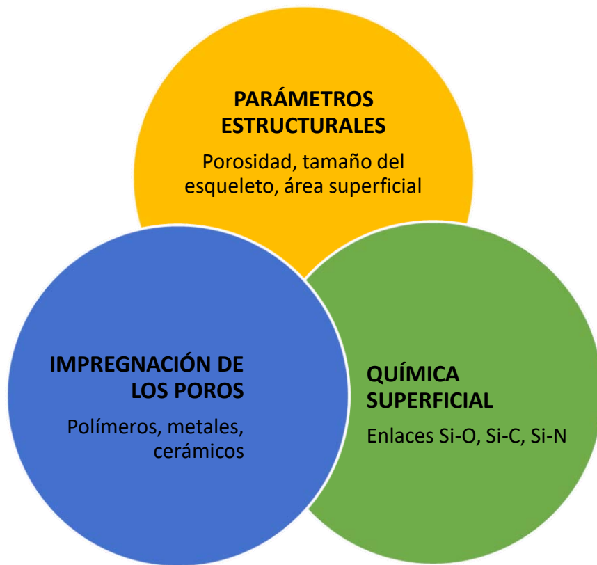
Figura 8. Los tres parámetros para ajustar las propiedades del pSi con algunos ejemplos.
