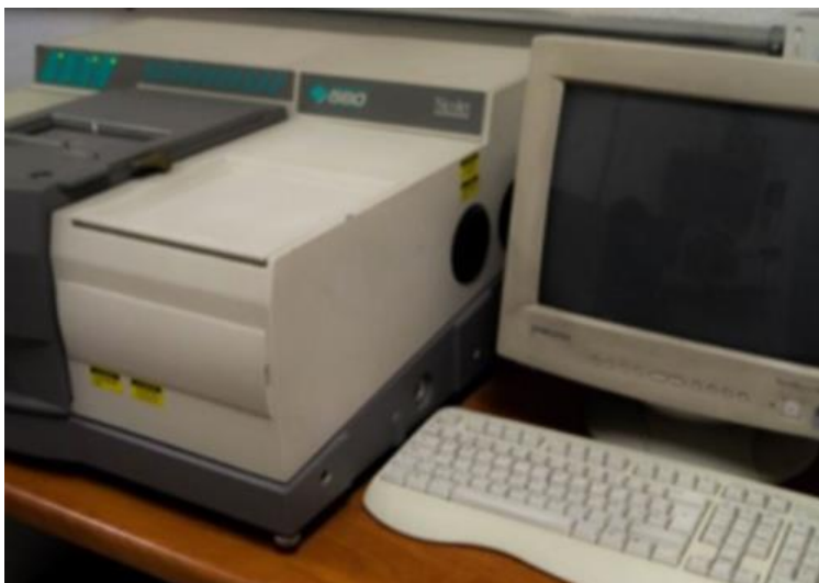
Figura 30. Equipo Nicolet 560 para obtención espectroscopia infrarroja
