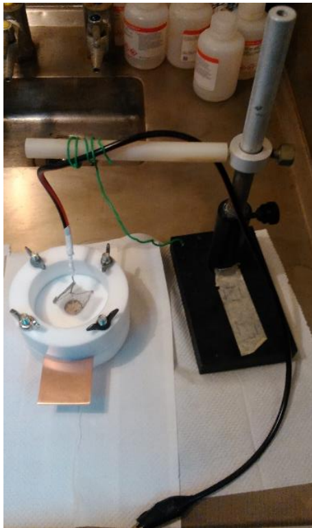
Figura 26. Celda electroquímica montada y diagrama de la celda
