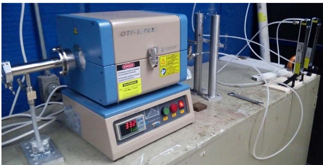
Figura 24. Equipo utilizado para el tratamiento térmico
