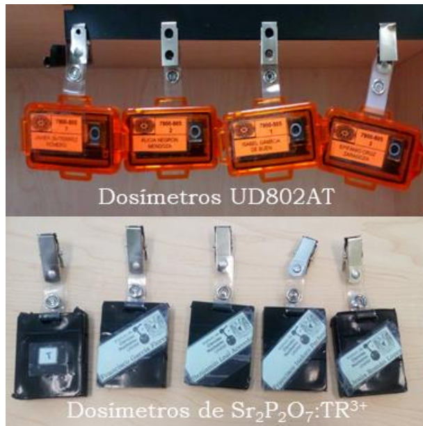
Figura 4.32 Dosímetro comercial UD802AT y pastillas de Sr 2 P 2 O 7 :TR 3+ , donde TR 3+ puede ser Ce 3+ , Tb 3+ y Tm 3+ 1.0 % mol.
