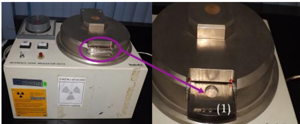
Figura 3.8 Irradiador Studsvik de partículas beta ^{90}\text{Sr}/^{90}\text{Y} . (1) Acercamiento al sitio donde se colocan las muestras.
