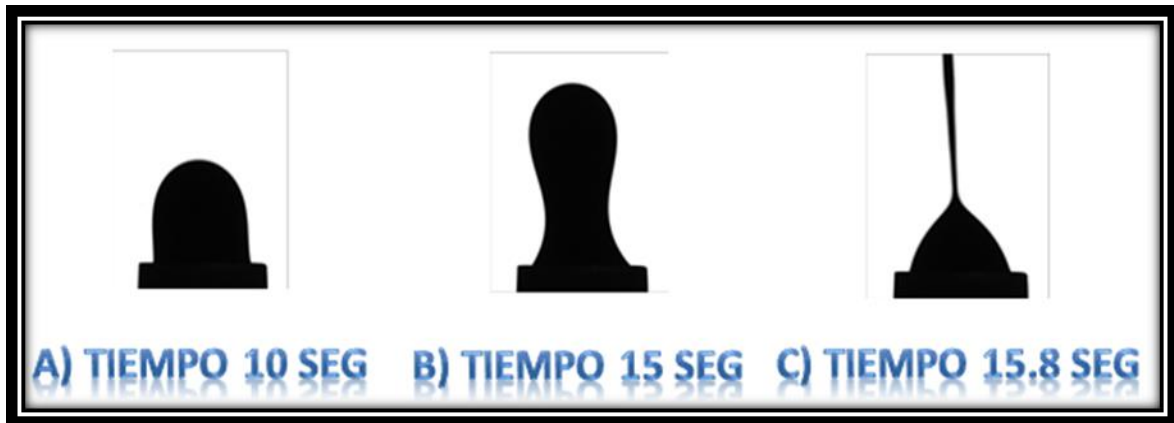
Figura 33 Experimento de burbuja ascendente con una tensión interfacial de 0.5 [dina/cm]
