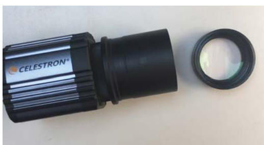
Figura 3.12: Imagen de la cámara SkyRis 445M y el reductor focal.
