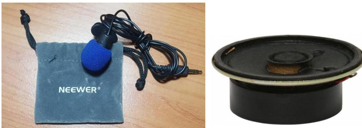
Figura 3.5 Micrófono de solapa *Neewer* y bocina 1.5 [W] [292].
