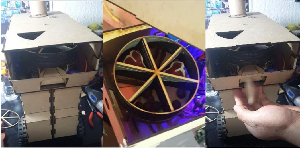
Figura 4.20. Sistema de dosificación posicionado y lleno de premios para pruebas.
