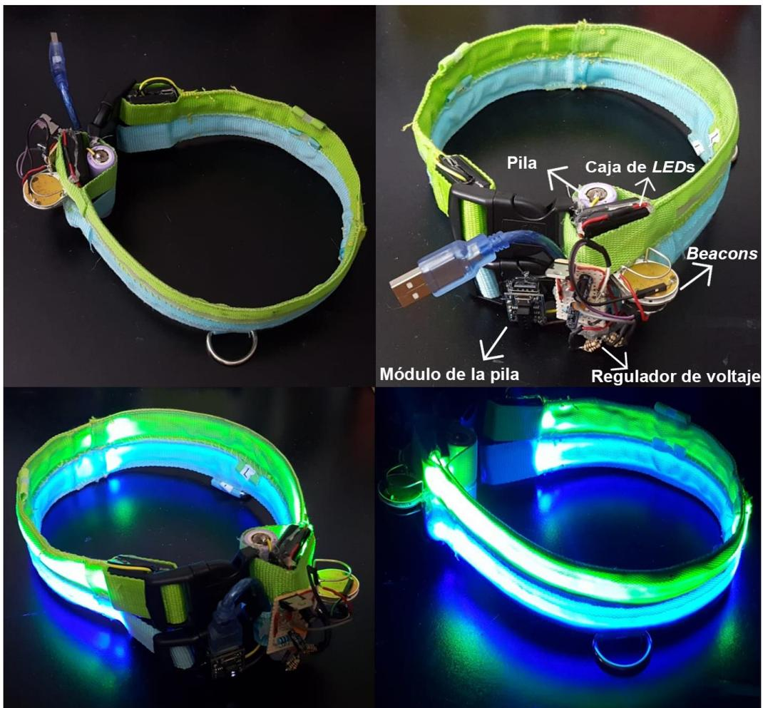
Figura 4.1 Configuración final del collar de la mascota.
