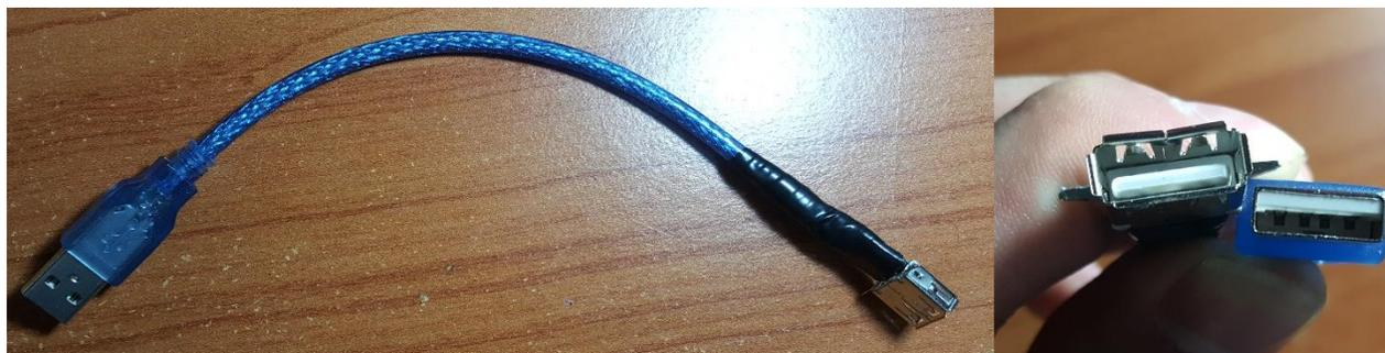
Figura 3.2 Extensión para la transferencia de datos por *USB*.
