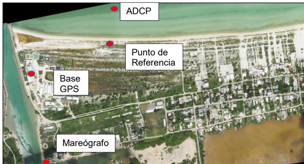
*Figura 10. Ubicación de los equipos utilizados para medir las condiciones mareográficas y puntos de referencias usados durante los levantamientos topográficos.*
