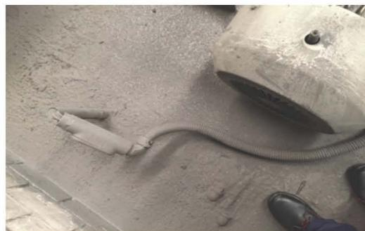
**Imagen 4. Uso de cartón como protección a las aletas del motor**
