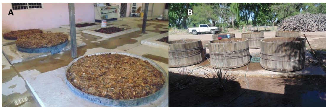
Figura 7. Fermentación en plias: A) Pilas de fermentación de cemento y de plástico. B) Tinajas de fermentación de madera.
