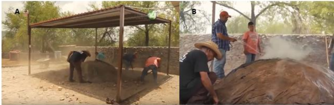
Figura 4. Cubiera de los hornos. A) Productores tapando con tierra y hojas el horno de cocción. B) Rocío con agua del horno de cocción (TV UNAM, 2017).
