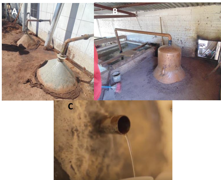
Figura 8. Destilación. A y B) Distintos alambiques, se observa que están sellados con lodo y bagazo. C) Obtención del líquido en un carrizo que desemboca en un recipiente de recolección.
