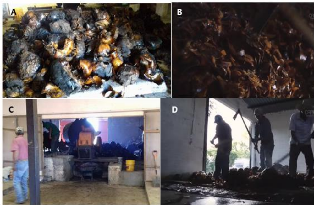
Figura 6. Molienda de los tallos: A) Tallos listos para ser cortados B) Tallos molidos en trozos o fibras pequeñas C) Trilladora empleada para moler las piñas. D) Molienda con hacha. Imágenes A, B y D (TV UNAM, 2017).
