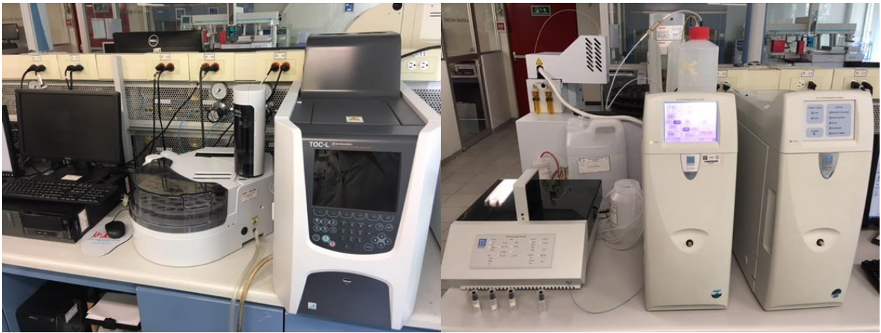
Ilustración 4 Equipo Shimadzu TOC-LSH y TLM-L (izquierda) y cromatógrafo DIONEX ICS-2000 RFIC (derecha)
