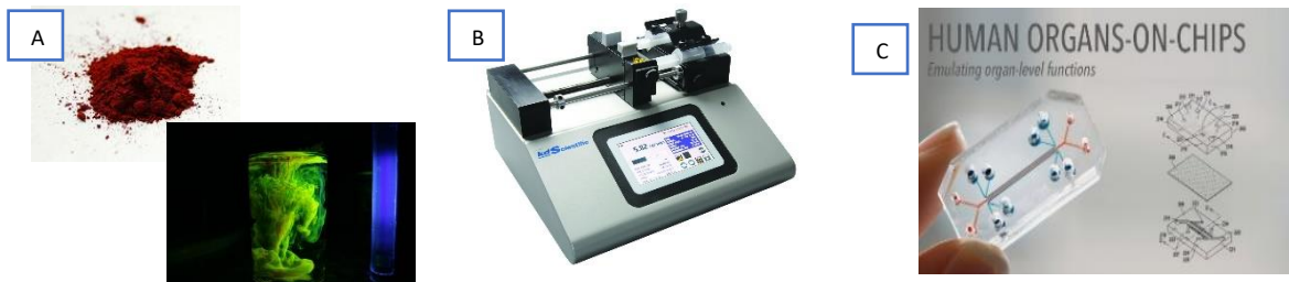
FIGURA 4-2. A) IMÁGENES DEL COMPUESTO LLAMADO FLUORESCÉINA SÓDICA EN POLVO Y DILUYÉNDOSE. B) BOMBA PARA INYECCIÓN/RETRACCIÓN DE ALTA RESOLUCIÓN [E], C) EJEMPLO DE UN CHIP MICROFLUÍDICO [F].
