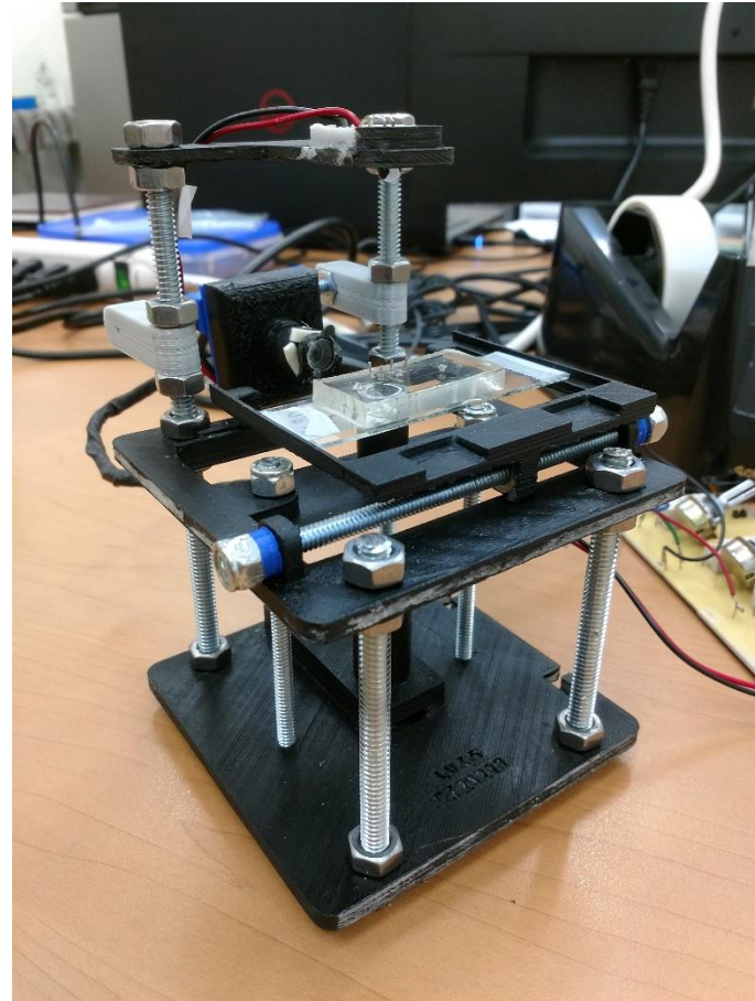
FIGURA 0-16. FOTOGRAFÍAS DEL DISEÑO FINAL CONSTRUIDO EN DOS ETAPAS: LA PRIMERA SIN EL USO DE UNA CAPA DE COLOR NEGRO Y OTRA CON ESTA CAPA. LA FINALIDAD DE ESTE RECUBRIMIENTO DE COLOR ES EVITAR QUE LA LUZ RESIDUAL DE LA FUENTE DE LUZ DE EXCITACIÓN DEL MINI MICROSCOPIO INCIDA SOBRE EL SENSOR DE LA CÁMARA WEB, MODIFICANDO LOS RESULTADOS QUE SE PUEDAN OBTENER.
