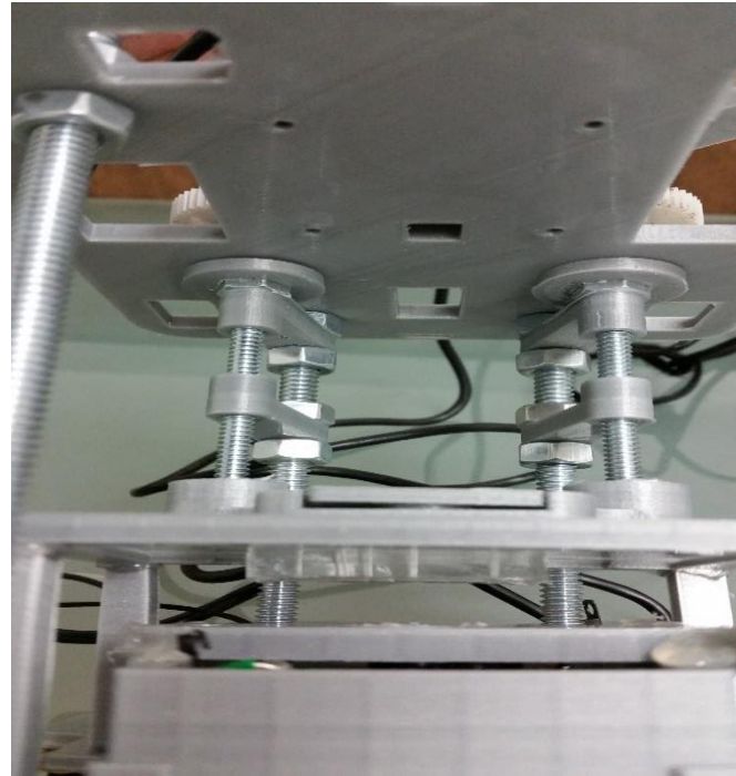
FIGURA 0-3. IMÁGENES DONDE SE MUESTRA, POR UN LADO, LA ILUMINACIÓN UBICADA EN LA BASE DEL MINI MICROSCOPIO IRRADIANDO LUZ BLANCA POR DEBAJO DE LA PLATINA CON UN CHIP DE MICRO FLUÍDICA, Y UNA FOTOGRAFÍA DEL INFERIOR DE LA PIEZA DE ESTRUCTURA SUPERIOR PARA HACER ÉNFASIS EN EL ORIFICIO DONDE PASA LA LUZ AL SENSOR PARA LA DETECCIÓN DE IMÁGENES MAGNIFICADAS.
