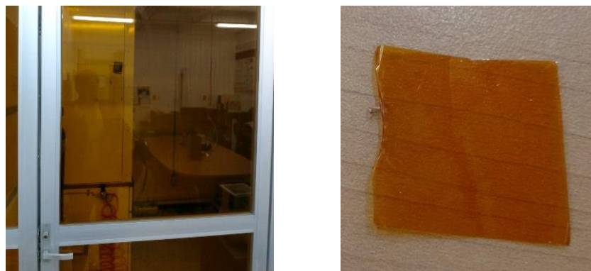
FIGURA 0-10. FOTOGRAFÍAS DE LA MICA PARA VENTANAS QUE FILTRA LA LUZ UV.
