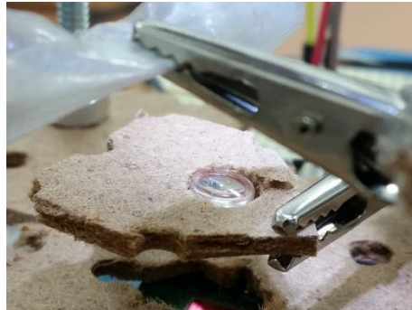
FIGURA 0-1. BASE DELENTE DE APUNTADOR LÁSER, EJEMPLO DE LOS FABRICADOS CON PROPÓSITOS DE PRUEBAS.
