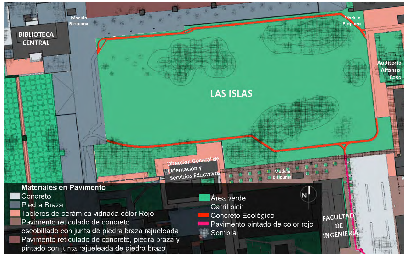
Imagen 3-1 "Plano de material de pavimento en A27". Elaborado por Nami Ota, en octubre 2016
