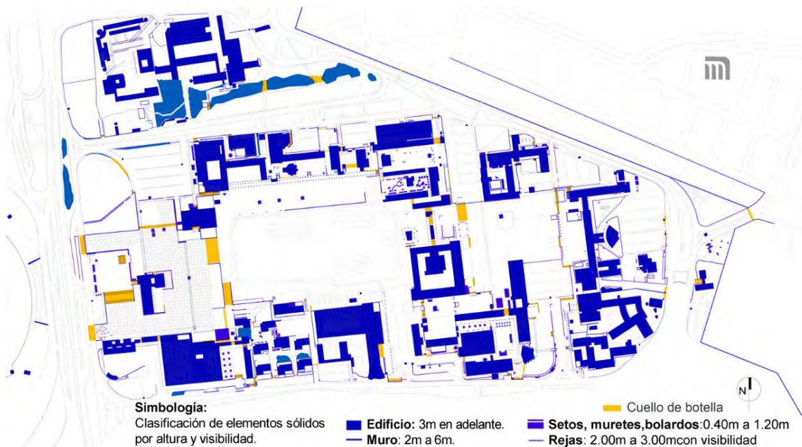
Imagen 80 “Plano de límites Sólidos con cuello de botella en el Campus Central”. Elaborado por, Nami Ota, en mayo 2013.
