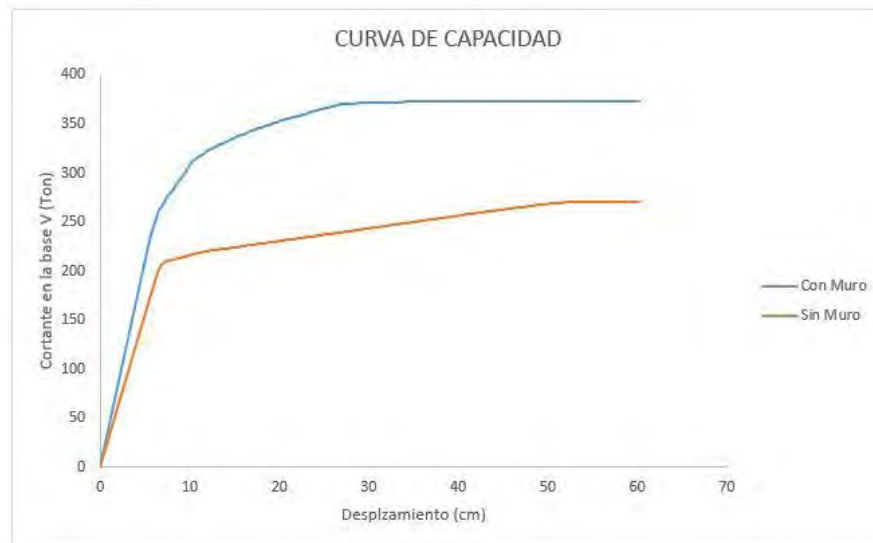
Figura 6-1 Curvas de capacidad, estructura con muros vs estructura sin muros.
