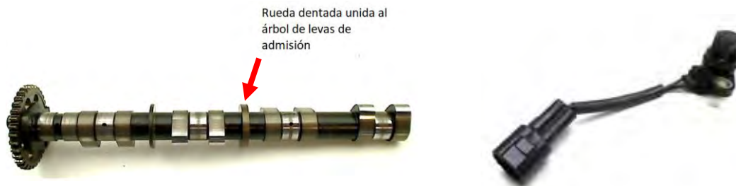
Ilustración 2.3.1.2 Sensor de efecto Hall. En la fotografía podemos observar el sensor original incluido en el motor (derecho) y la rueda que está unida al árbol de levas de los puertos de admisión (izquierdo). [9]
