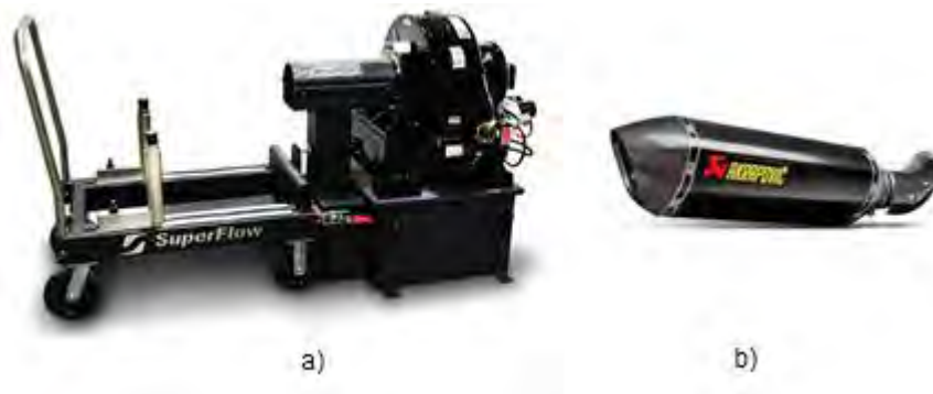
Ilustración 2.2.1. a) Dinamómetro de motor usado para obtener las curvas de par y potencia del motor Yamaha R6 2010. b) Silenciador de la marca AKRAPOVIC tipo Slip On usado durante las pruebas en dinamómetro.
