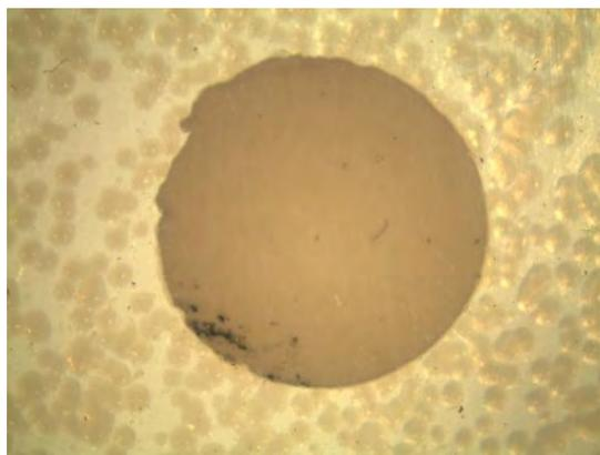
Figura 15. El ensayo de difusión de disco de las películas de almidón con incorporación de nanopartículas, la magnificación permite observar el
