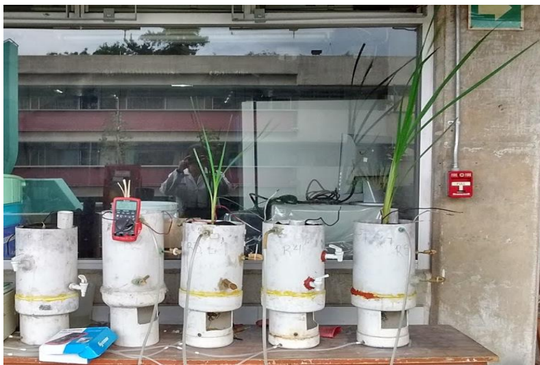
Figura 4.1. Humedales artificiales asistidos electroquímicamente
