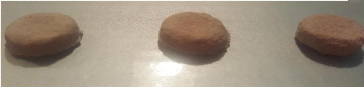
Fig.60. Prueba de erosión, matrices secas luego de 20 minutos de prueba.
