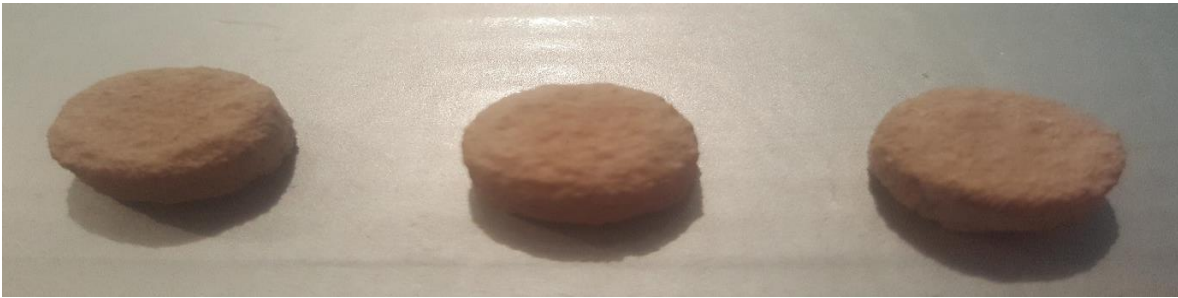
Fig.59. Prueba de erosión, matrices secas luego de 10 minutos de prueba.
