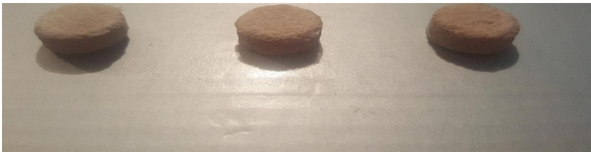
Fig.61. Prueba de erosión, matrices secas luego de 120 minutos de prueba.
