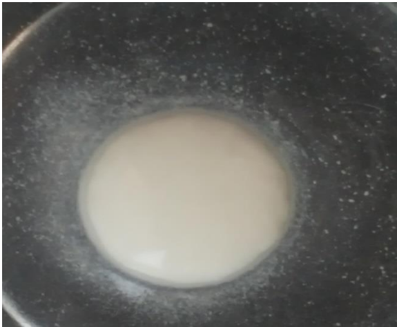
Fig.52. Prueba de hinchamiento, matrices a los 20 minutos de prueba.
