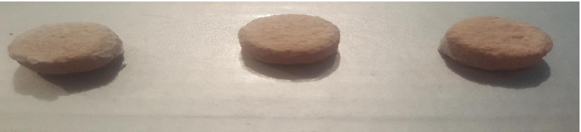
Fig.58. Prueba de erosión, matrices secas luego de 5 minutos de prueba.
