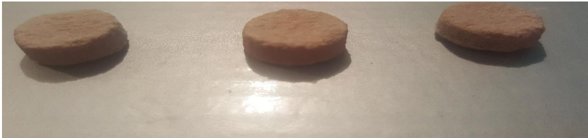
Fig.57. Prueba de erosión, matrices secas luego de 2 minutos de prueba.
