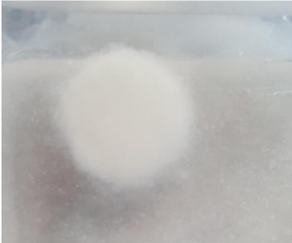
Fig.46. Prueba de hinchamiento, matrices a los 2 minutos de prueba.
