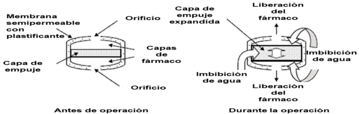
Figura 2. Sistema osmótico y mecanismo de liberación del principio activo a través de dicho sistema (Modificado de BAENA, et al 2006).
