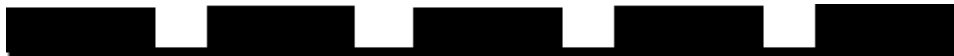
Figura 12. Representación del acetato en negativo que contiene el diseño del microchip vista lateralmente. Los rectángulos blancos representan las secciones donde hay canales mientras que los negros representan los espacios donde no los hay.
