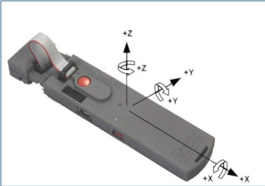
**Figura 6.** Modelo de la Enactive Torch utilizada en el experimento. Las flechas negras indican la dirección del registro de cada acelerómetro. Las flechas blancas la orientación de los giroscopios. Imagen tomada de: <https://github.com/CreativeRobotics/EnactiveTorchRT/tree/master/Instructions>
