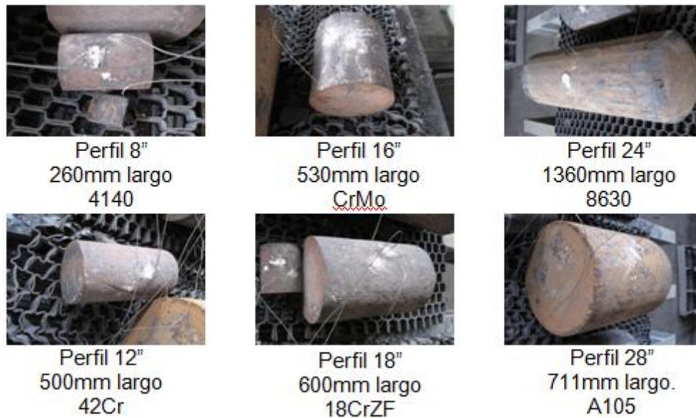
Figura 3.1 Fotografías de las probetas utilizadas para la medición de curvas de enfriamiento en planta.
