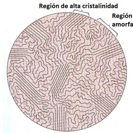
**Figura 2.3:** Representación de la estructura semicristalina de un polímero, donde se aprecian las regiones amorfas y cristalinas [15].
