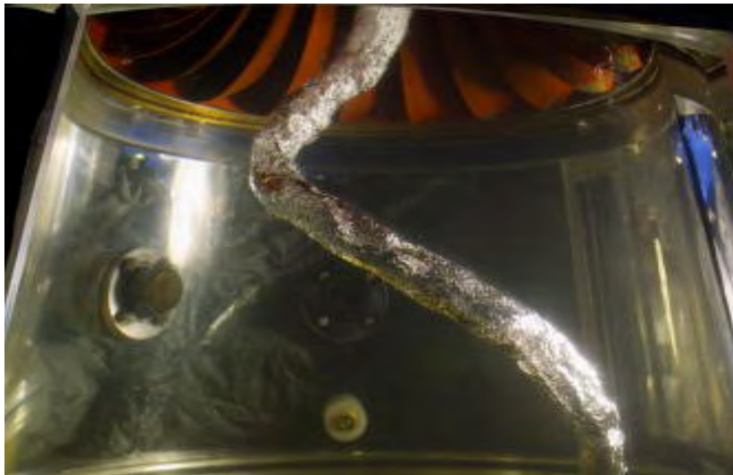
Figura 4.5: El flujo helicoidal toma la forma de un tirabuzón.
