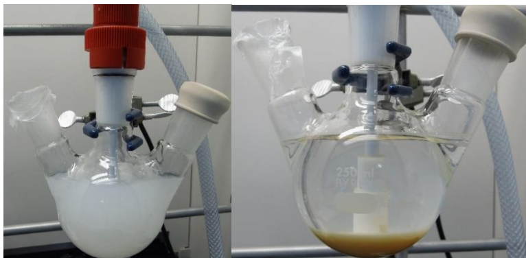
Figura. 2 Cambios en la coloración durante la síntesis de Hidroxiapatita de izquierda a derecha, blanco y amarillo.
