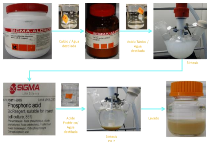
Figura.3 Diagrama completo del proceso de síntesis de hidroxapatita.
