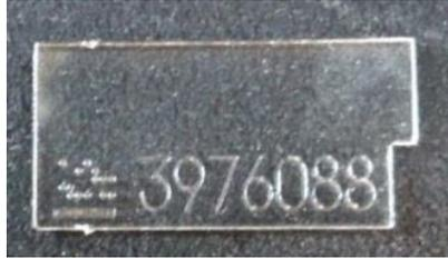
Figura 3.2. Detectores CR-39 utilizados en el proceso experimental.
