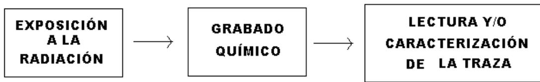
Diagrama 1.1 .Se muestran los pasos del método de detección por Trazas Nucleares en Sólidos.
