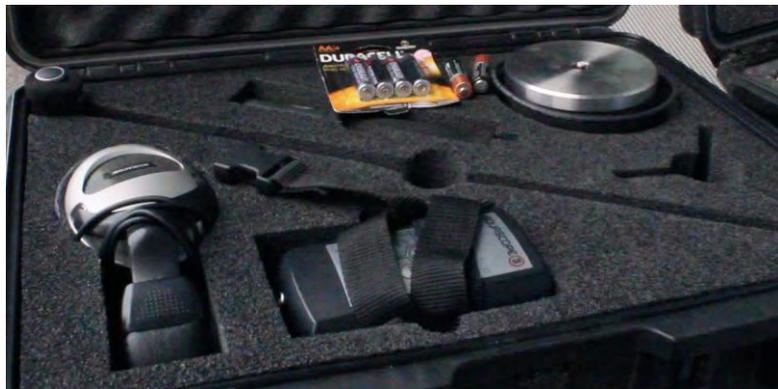
del sonido con la finalidad de obtener la ubicación de la fuga. Este barrido se da por medio del uso del geófono que consta de una varilla, unos audífonos y un dispositivo que permitirá escuchar el sonido del flujo en las líneas de distribución. Al tener la ubicación exacta de la fuga se realiza una perforación del medio y se observa si hay flujo de agua no previsto y exterior a las tuberías; de igual forma existen factores
