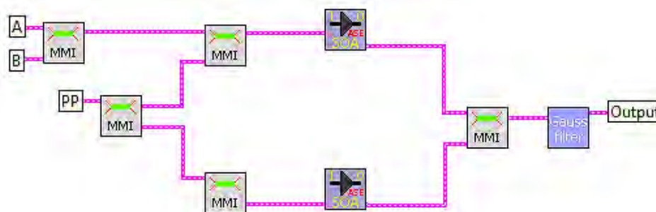
Figura 5.17. Compuerta OR convencional en el entorno LabVIEW.
