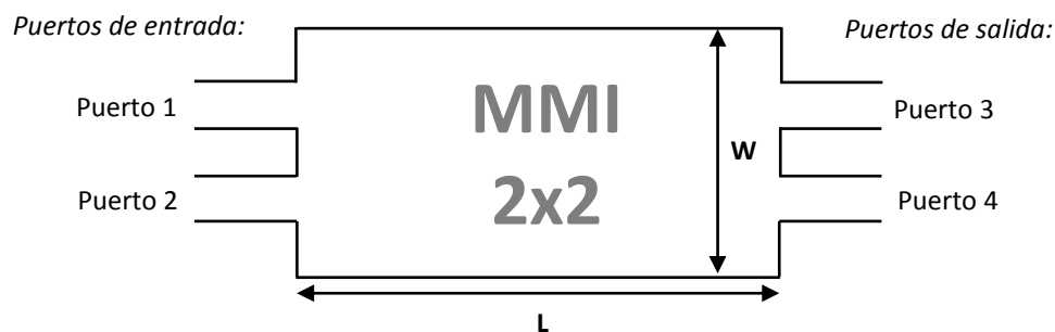
Figura 5.3. Diagrama esquemático de un acoplador MMI 2x2.
