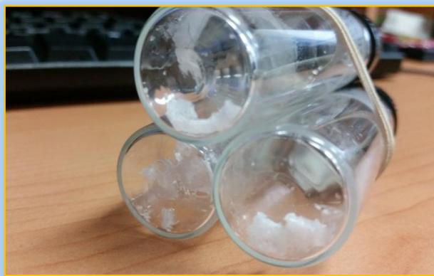
Ilustración 4.8 "Copolímeros Formados con  $PS_{BPM}$  y  $PMMA_{BPM}$ ". Mezclas 25/75, 50/50 y 75/25 sometidas a 90 min de estrés ultrasónico a 1.2 MHz.
