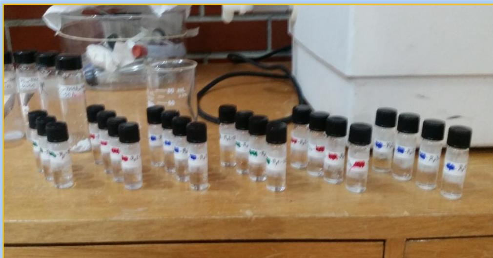
Ilustración 4.6 "Sistemas Poliméricos Sometidos a Estrés Ultrasónico de 42 kHz". Series 1 y 3 de  $PS_{BPM}$  y  $PS_{APM}$ , respectivamente de concentración al 2.5%. Las marcas de color presentes en las etiquetas designan el solvente empleado: Verde (Cloroformo), Rojo (Tetrahidrofurano), Azul (Tolueno).
