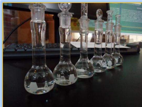
Ilustración 4.4 "Soluciones de Poliestireno PS<sub>v</sub> para las Pruebas Viscosimétricas"
