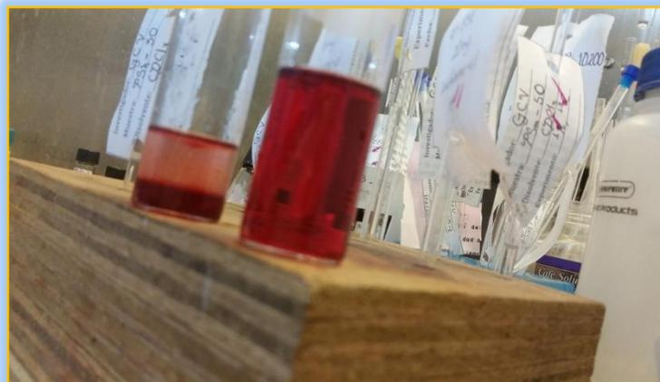
Ilustración 4.20 "Preparación del Sistema Polimérico-Rojo Disperso 1  $PS_{APM}-PMMA_{BPM}-RD-1'$  (Al frente)". El sistema fue sometido a 90 min de estrés ultrasónico a 1.2 MHz. Al fondo yace una solución de agua y  $CHCl_3$ , donde se observa la solubilidad del RD-1.
