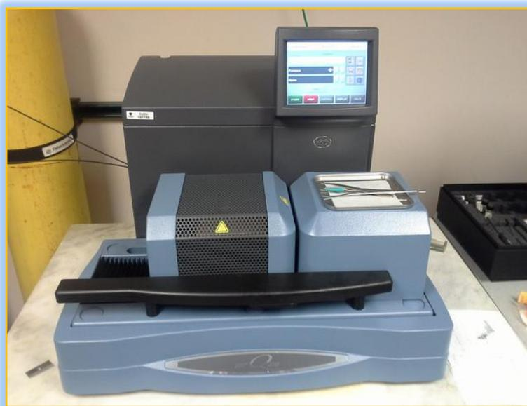
Ilustración 7.14 "Equipo de Análisis Térmico". En instrumentos como el aquí mostrado, por lo general se obtienen curvas de Análisis Termogravimétrico (TGA) y Calorimetría Diferencial de Barrido (DSC) <sup>69</sup>.
