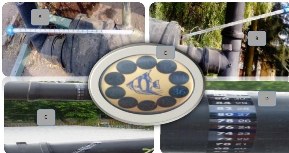
Figura 10. Termómetros de  $-20^{\circ}\text{C}$  a  $150^{\circ}\text{C}$  (A y B) utilizados en el recirculador y primer almacenador respectivamente, los termómetros adheribles, (C) colocados en el primer y segundo almacenador, (D) colocado en el tercer contenedor de las plantas y sustratos y por último (E) colocado en el recirculador.
