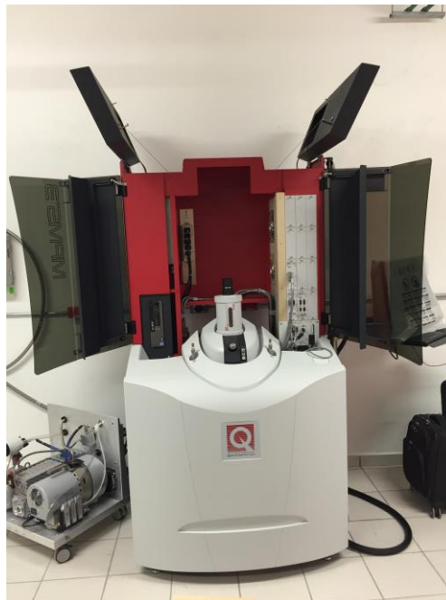
Figura I.18 dispositivo SQUID MPMS3, con un campo máximo de 2T, y con un rango de temperatura de 2 a 430 K, localizado en el IFUNAM.
