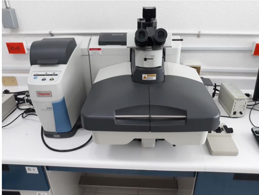
Figura I.14 dispositivo Thermo Scientific DXR Raman Microscope, con longitud de onda de 633 nm, localizado en el IFUNAM.
