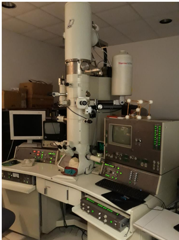
Figura I.11 Microscopio JEOL JEM-2010F FasTem a 200 keV en IFUNAM
