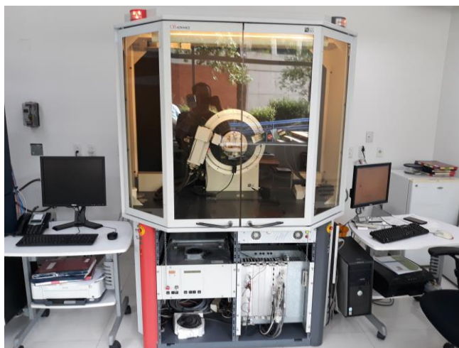
Figura I.13 PXRD D8 Advance Bruker AXS con \lambda = 1.5406 \text{ \AA} de Fuente de cobre. Localizado en el IFUNAM.
