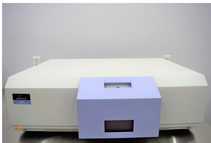
Figura I.16 Perkin Elmer con una excitación variable, en este trabajo se usó una excitación de 290 nm, con la cual se pudieron observar diferentes emisiones provenientes de las nanopartículas sintetizadas.
