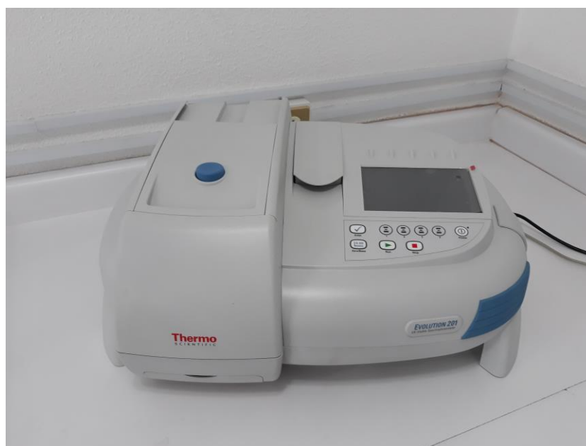
Figura I.15 Dispositivo Evolution 201 UV-Visible con espectro de 1000 nm a 190 nm localizado en el IFUNAM.
