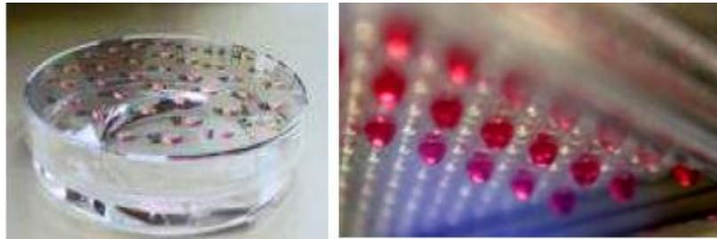
**Fig. 6** Fotografía que muestra el método de la gota colgante.<sup>27</sup>
