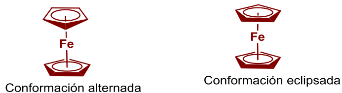
Figura 1. Estructura del ferroceno propuesta por Wilkinson y Woodward
