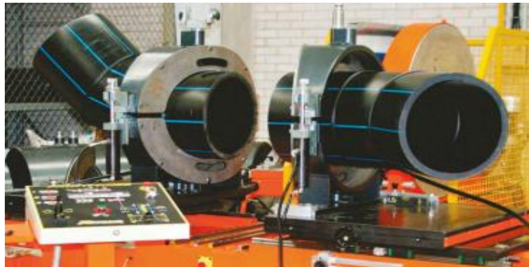
Ilustración 6: Sistema de unión para tubería de Polietileno.
