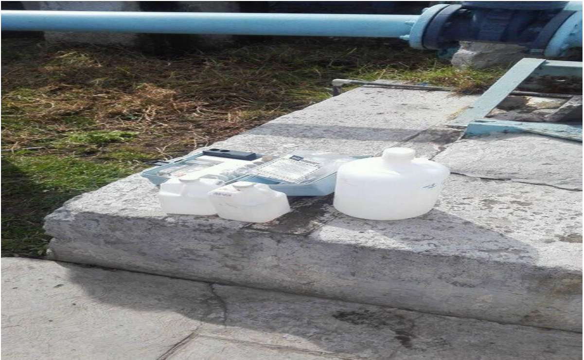
Ilustración 44: Recipientes para recolectar muestras de agua de la fuente de abastecimiento y posteriormente ser llevadas a laboratorio.
