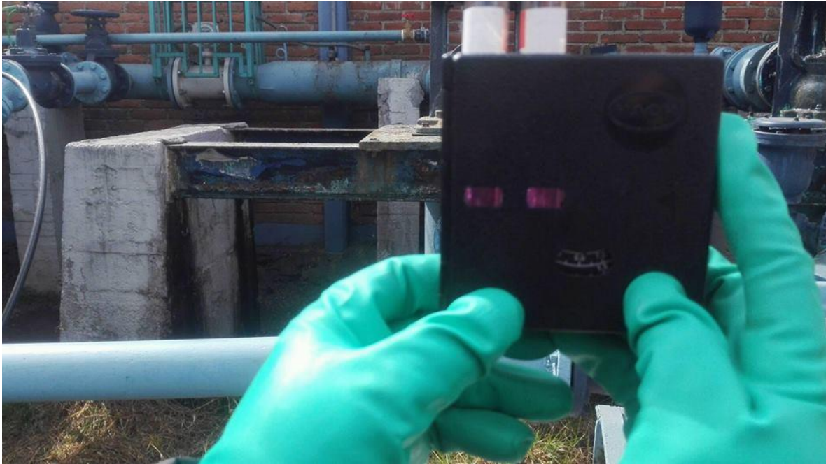
Ilustración 35: Toma de lectura para determinar índice de cloro libre en el agua de abastecimiento, realizada por personal del sistema de aguas de la ciudad de México.
