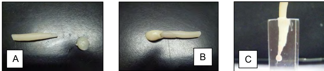
Figura 14. Fabricación, conformación e inmersión de perno de composite. Fuente: Directa
