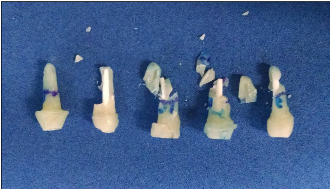
Figura 25. Pernos de fibra de vidrio y composite de nanorelleno después de prueba de flexión. Fuente: Directa
