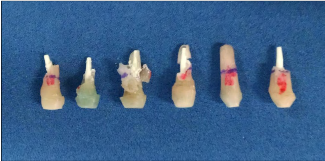
Figura 24. Pernos de fibra de vidrio y composite de microrelleno después de prueba de flexión. Fuente: Directa
