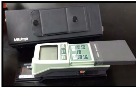
Figura 12. Perfilómetro Mitutoyo® <sup>F.D.</sup>
